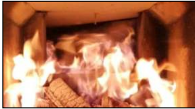
Anwendungsbeispiel Silca Woolboard HFS Gedämmte Brennraumdeckel wirken sich positiv auf die Emissionswerte aus.
